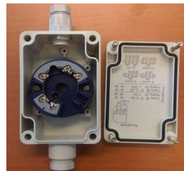
T03 B dans boîtier pour montage en saillie (option 243)
